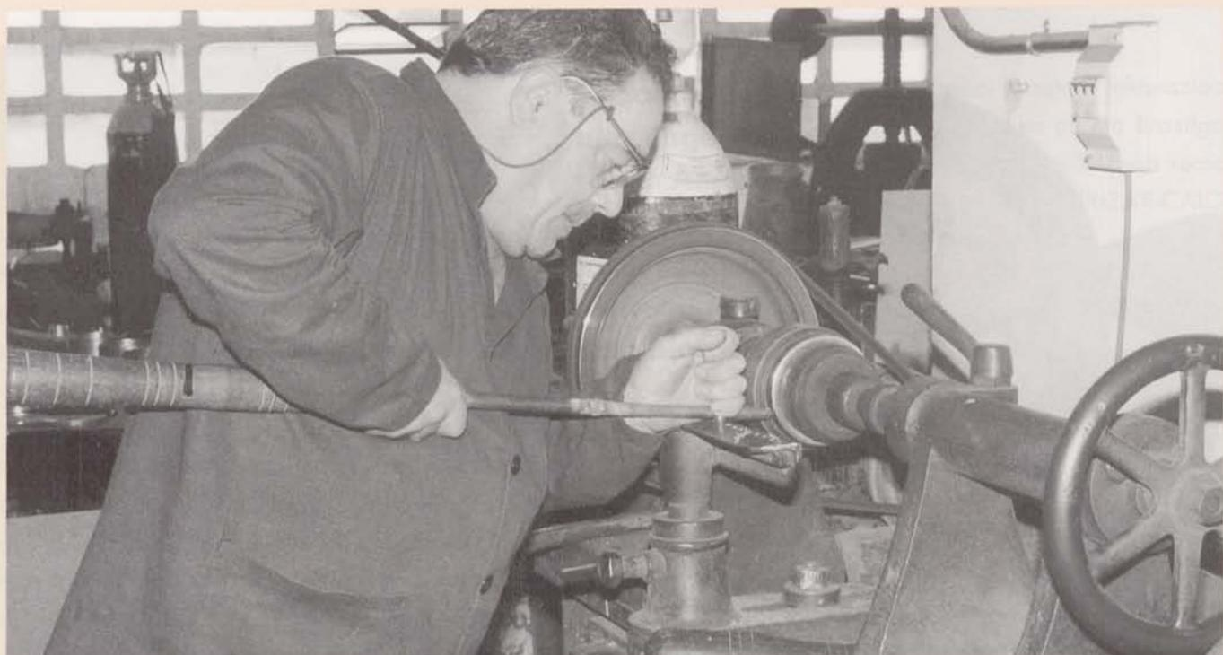
Dar forma abombada y sacar pestaña al fondo de una aceitera en torno utilizando un entallador. El trabajador se sujeta a la máquina mediante el tradicional cinturón que le permite más presión con menos esfuerzo (foto Amaia Ros 07/97).
