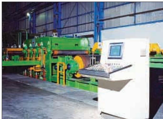
Equipos de línea CCMs, variadores de c.a, PLCs comunicados entre sí y con sistemas superiores, sensores, y equipamiento auxiliar: motores, motorreductores, frenos etc.
