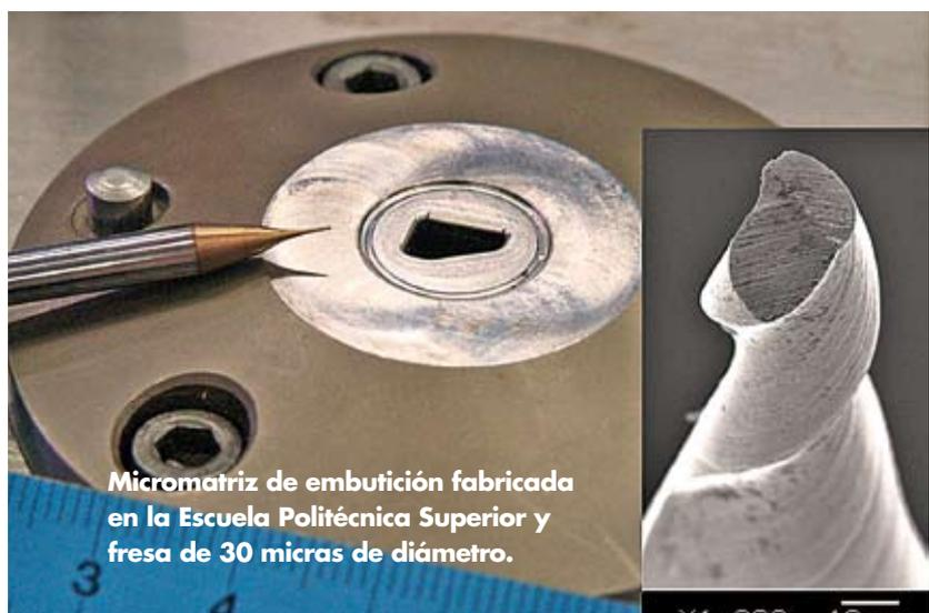
Micromatriz de embutición fabricada en la Escuela Politécnica Superior y fresa de 30 micras de diámetro.
