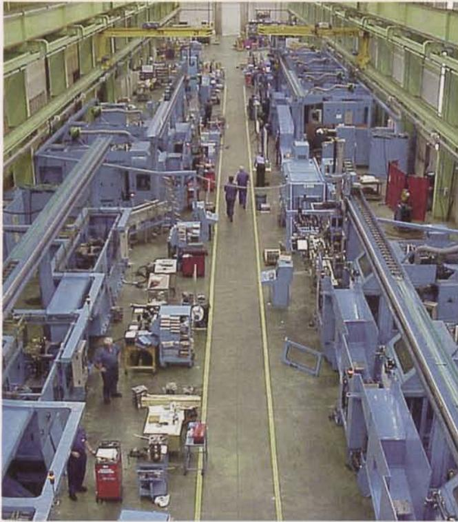
millones de pesetas. Esta línea es la tercera y última que compone el sistema "llave en mano" diseñado para el mecanizado completo de un motor de gasolina en aluminio de 4 cilindros y 2000 cc.
