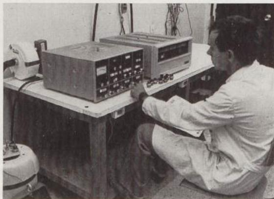
Ensayo de vibraciones de termocontactos en Zertan
