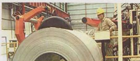
hasta 13mm. La alimentación de bobinas y la carga se producen de forma automática, y ambas operaciones están controladas por ordenador.
