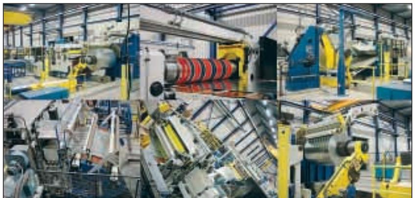
cizalla circular que permite realizar el cambio de cuchillas en unos 4 minutos. Adicionalmente existen sistemas de cambio rápido de los ejes separadores en el tensor y el enrollador.
