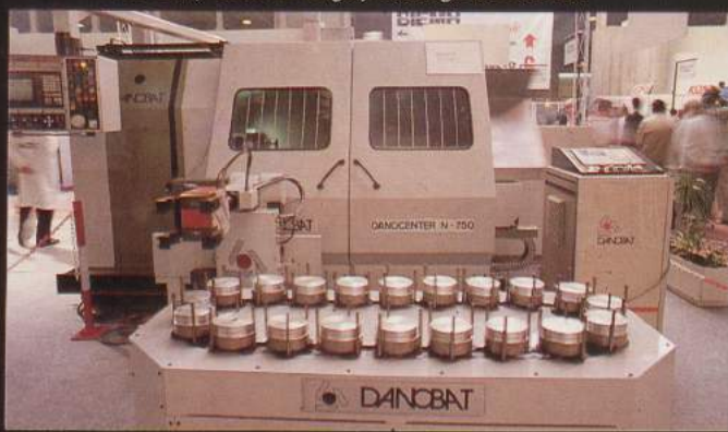
Torno con CN y robot de carga y descarga de Danobat
