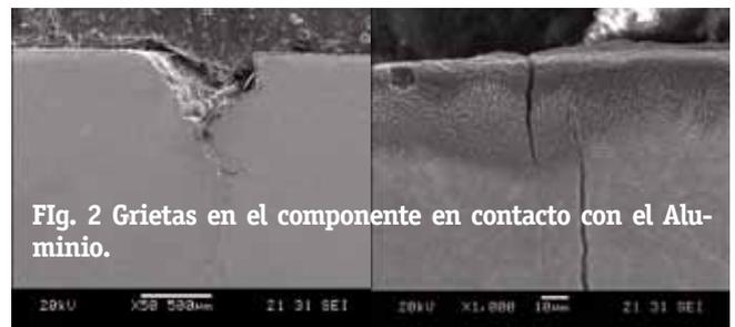
Fig. 2 Grietas en el componente en contacto con el Aluminio.
