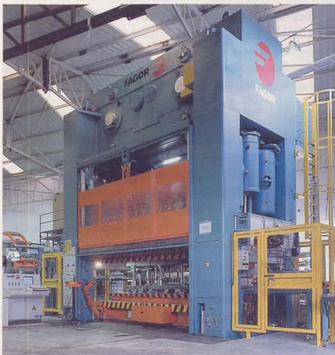
Fagor Arrasate ha dotado a esta prensa de dispositivos tendentes al aumento de flexibilidad y automatización para la adaptación a diferentes tipos de trabajo de estampación, la reducción de tiempos de cambio de útiles y un sistema de diagnóstico de averías, control de producción y asistencia técnica vía módem.
