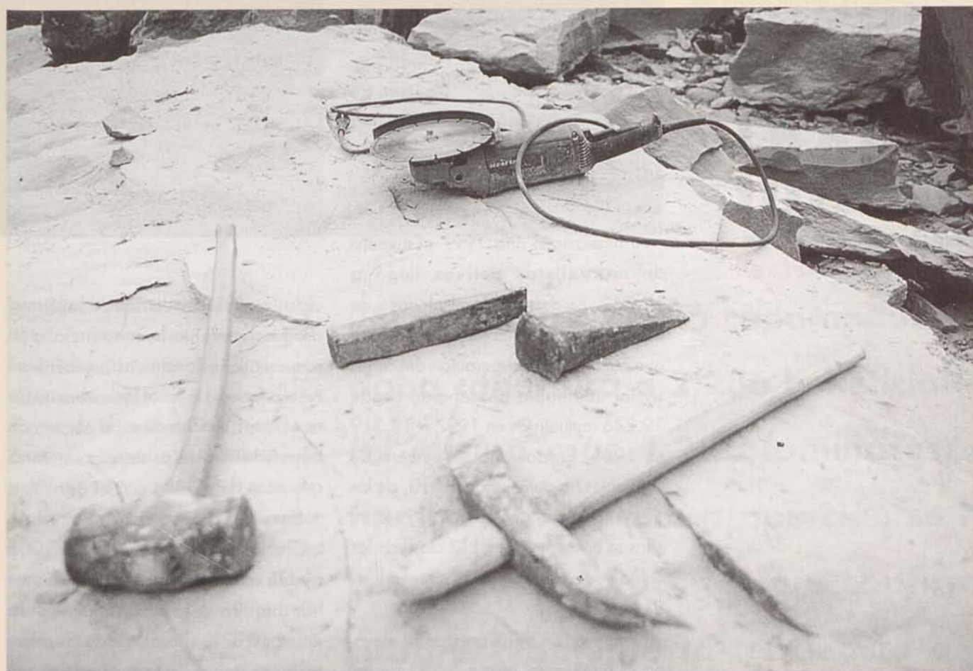
Herramientas utilizadas por los canteros labrantes, como cuñas, mazo, piqueta y amoladora eléctrica. (Foto Amala Ros, 03.98).
